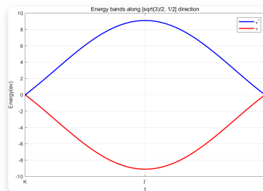
Figure 5.4. K- \Gamma -K 二维能带结构
